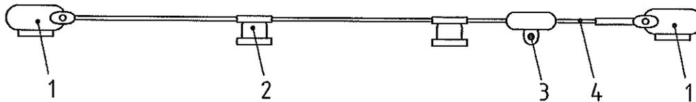
figura 7 Esempio di dispositivo di ancoraggio di tipo D
